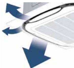
Distribución radial del aire en 360°.
